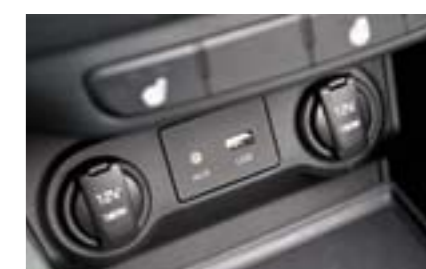
Две 12-вольтовые розетки в легкодоступной зоне и разъемы Aux и USB между ними – это уже можно назвать корейским стандартом
