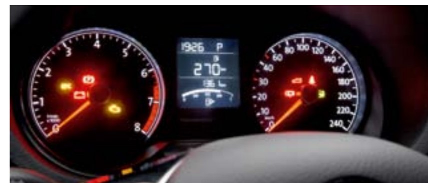
Оцифровка спидометра Polo — с переменным шагом, а центральный дисплей скуден на информацию
