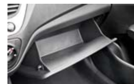
Бардачок по-прежнему не имеет подсветки и охлаждения: просто объемистый лоток из гулкой пластмассы с держателем для визиток
