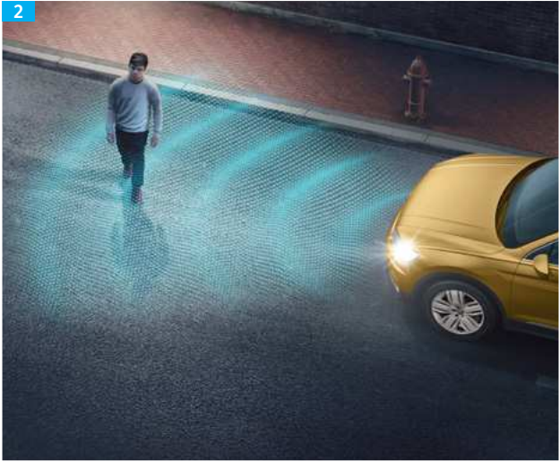
2 Следит за Вами и за другими: система контроля дистанции спереди Front Assist со встроенной автоматической функцией торможения City Emergency Braking предупреждает водителя о препятствиях на полосе движения. При отсутствии реакции со стороны водителя система осуществляет автоматическое торможение. P H C
