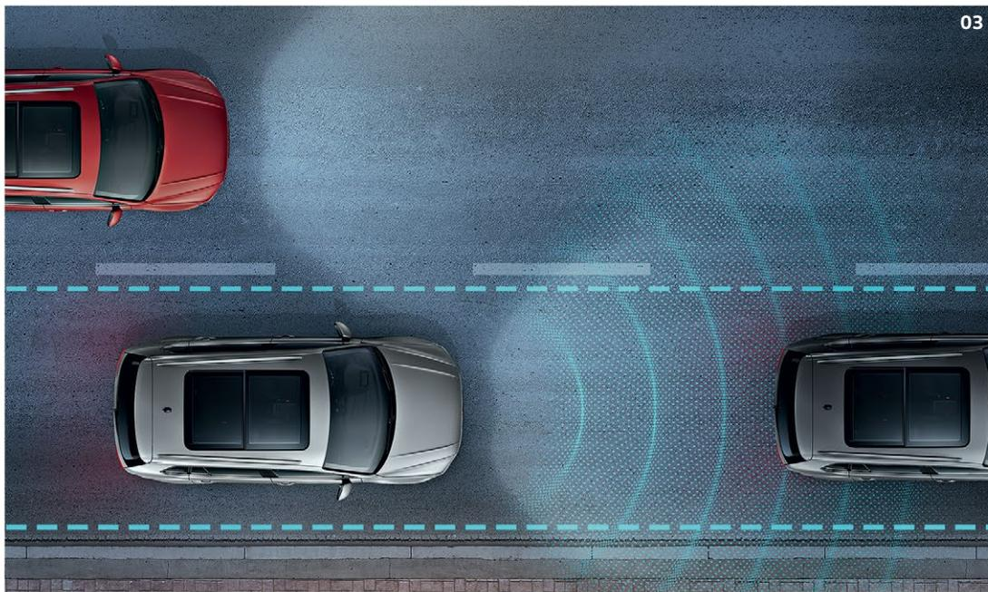
**03** Ассистент движения по полосе Lane Assist поможет держаться намеченного курса. Если автомобиль начнет смещаться без включенного сигнала поворота, электроника вернет его к центру полосы движения **50**
