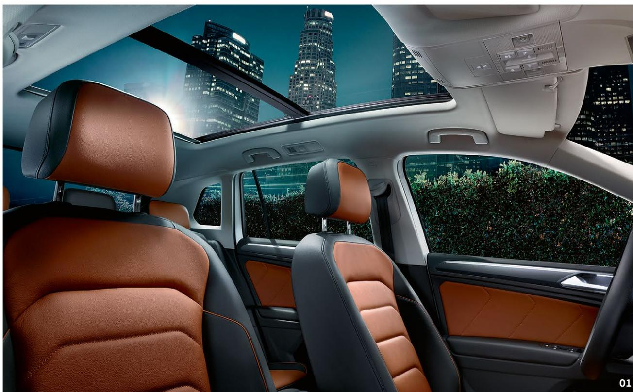
**01** Панорамная сдвижная крыша погружает салон в приятную атмосферу и позволяет свободно наслаждаться свежим воздухом и безоблачным небом над головой. Передний стеклянный сегмент оснащен электроприводом и может сдвигаться, подниматься и опускаться **SO**
